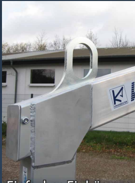
Einfaches Einhängen des Kranhakens
