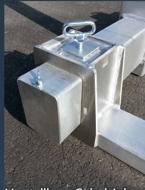
Verstellbare Gabelzinken, speziell geschweißte Profile für hohe Belastbarkeit
