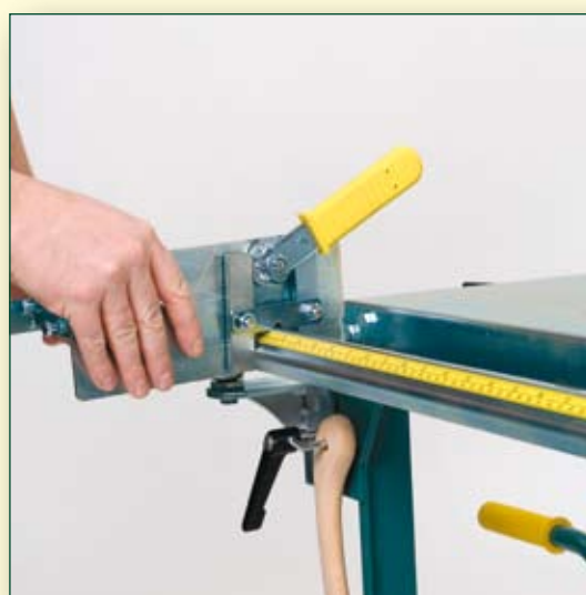
Innfesting av rulleanlegg
